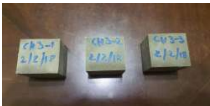
Figura 3. 7 Cubos de Cemento Híbrido
