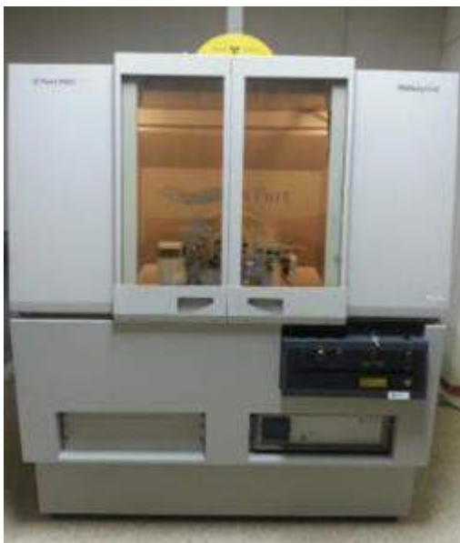
Figura 3. 10: Difractómetro de Rayos X, PANalytical® X'Pert PRO
