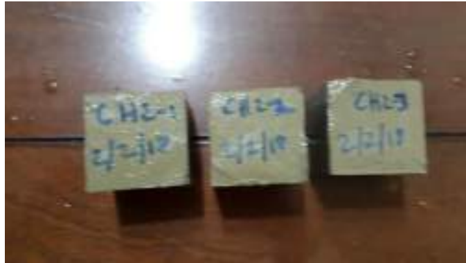
Figura 3. 8: Cubos de Cemento Híbrido
