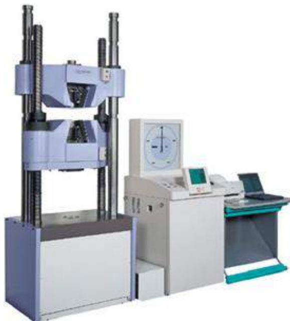
Figura 3.9: Maquina Universal SHIMADZU modelo UTM-600KN
